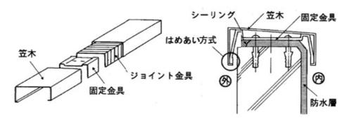
笠木本体・・・ アルミニウム合金押出形材もしくはアルミニウム合金板材折曲げ形に表面処理を
